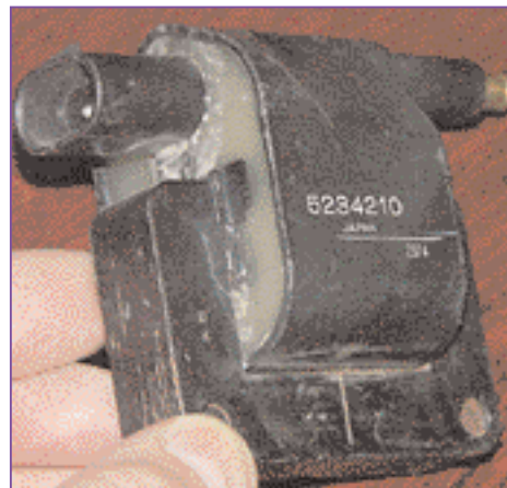
Эта катушка зажигания также имеет сухозаполненную конструкцию. Изготовленная в Японии, она применялась на автомобилях Jeep Grand Cherokee и часто была причиной проблем с двигателем.
