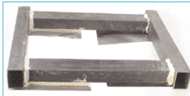
MS-полимеры способны собрать раму и приклеить к металлу и металл, и пластик, и бакфанеру — словом, любую облицовку транспортного средства.
