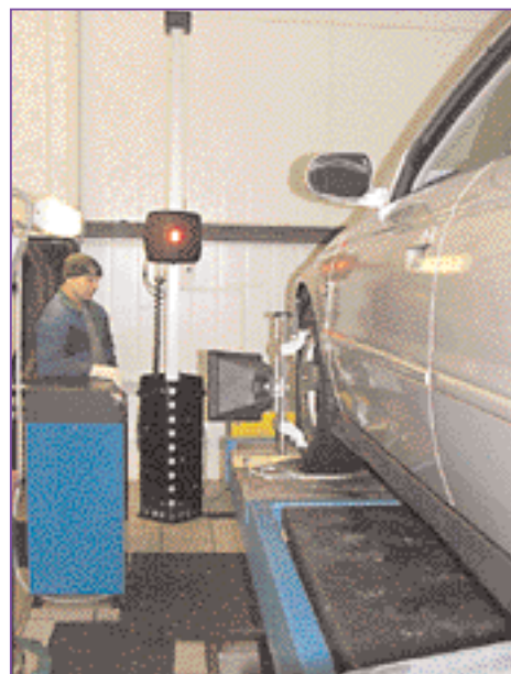
При подъеме автомобиля в положение для регулировки УУК автоматика стенда без вмешательства оператора отслеживает перемещение колесных мишеней, синхронно поднимая блоки камер.
