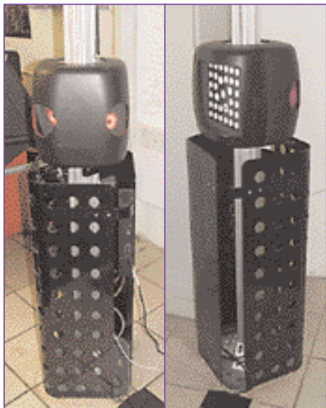
Жесткая механическая связь между камерами уступила место связи виртуальной. Она стала возможной благодаря размещению в одном из блоков дополнительной камеры (слева), а в другом — мишени (справа).
