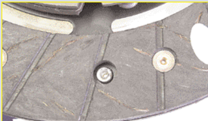
Эллипсоидные фрикционные накладки, глубоко утопленные надежные заклепки — характерные признаки современных дисков.
